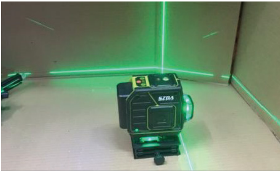
Dùng máy cân bằng laser định vị vị trí cần ốp
